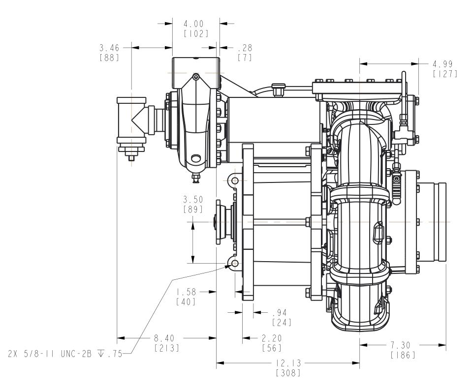
NOTES: I) WEIGHT = 559 LB. 2) THE 2ND STAGE CAN ONLY BE ENGAGED OR DIS-ENGAGED WHEN THE PTO IS DIS-ENGAGED. 3) THE 2ND STAGE SUCTION NEEDS TO BE PLUMBED BACK TO THE IST STAGE DISCHARGE.
