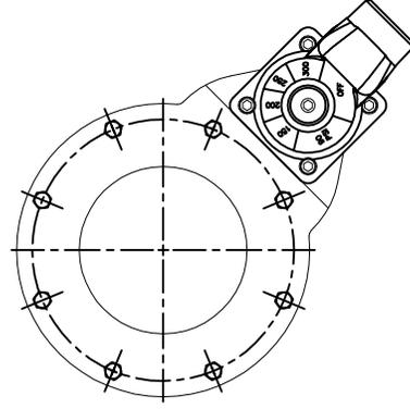
**TYPICAL SUCTION EXTENSION CONFIGURATION FOR EM, LDM, N, & S PUMP**
